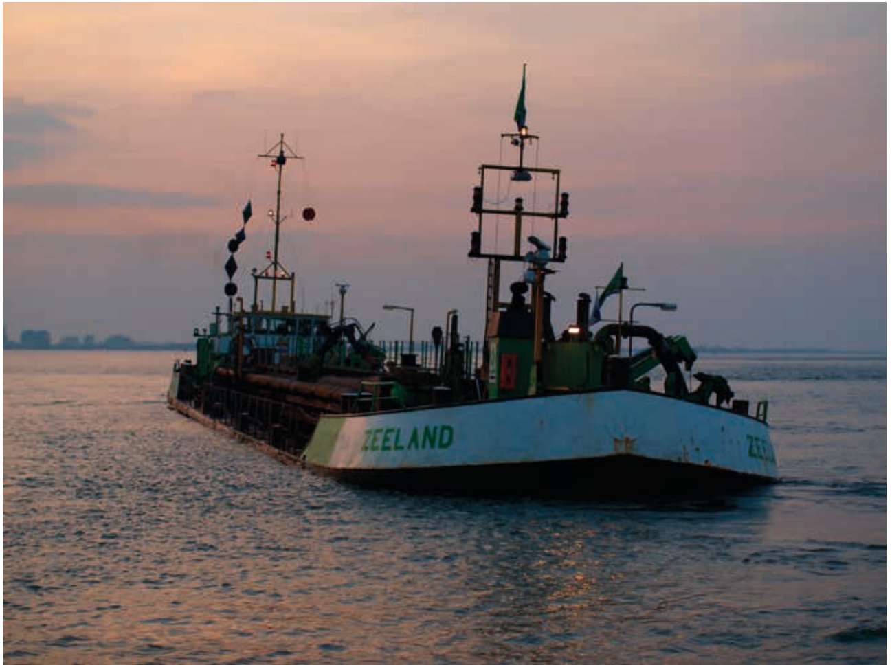
Figuur 2.9 Slephopperzuiger 'Zeeland' van De Vries & Van de Wiel
