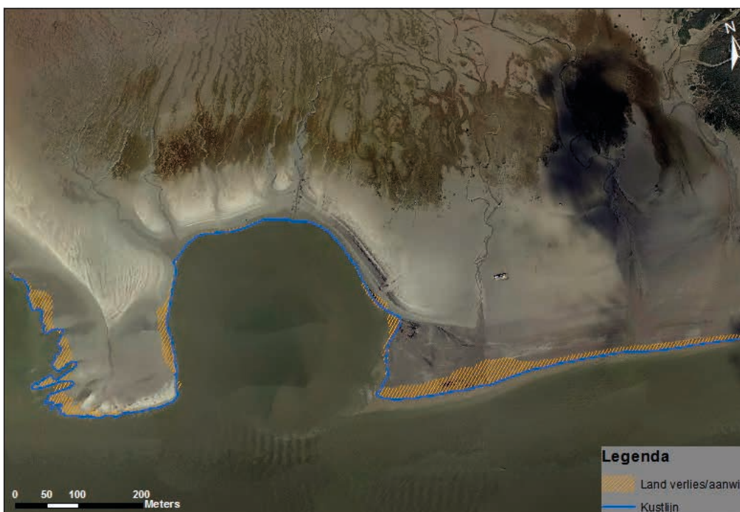
Figuur 3.22 Orthofoto met de verandering tussen vóór en ná het experiment door landaanwinst en -verlies
