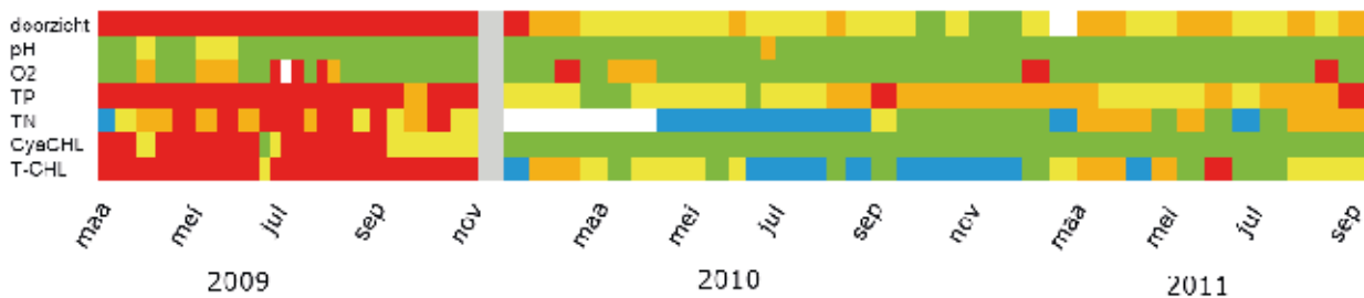
FIGUUR 22 EKR-Scores, uitgaande van de conceptmaatlaten voor het type M11 (kleine, ondiepe gebufferde wateren), voor een aantal fysisch-chemische waterkwaliteitsvariabelen in de ploeg gedurende de onderzoeksperiode maart 2009 tot en met september 2011. Grijs vlak geeft herinrichting weer
