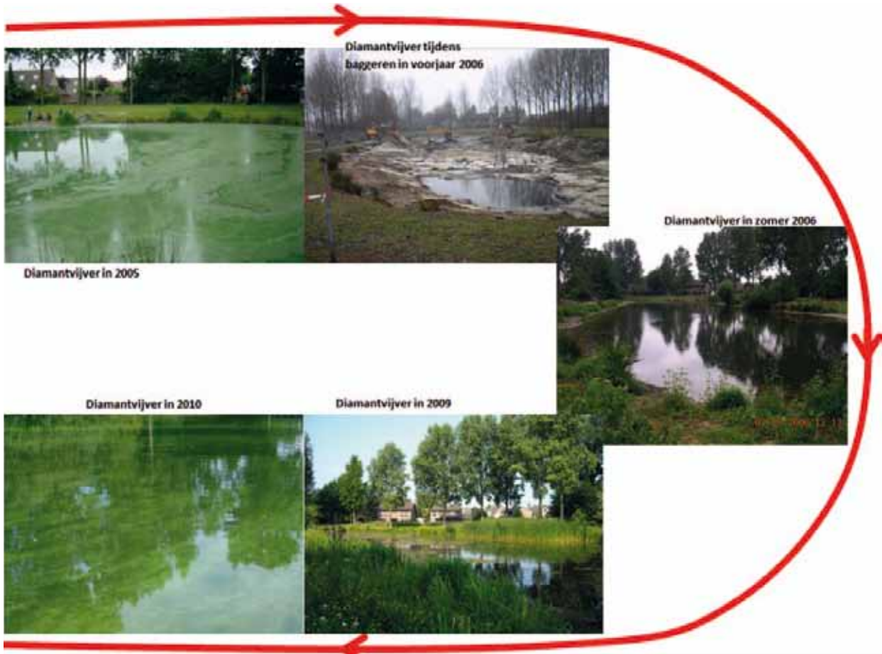
FIGUUR 24 BAGGEREN VIER JAAR EFFECTIEF TEGEN BLAUWALGEN IN STADSVIJVER OSS (2006-2009)
