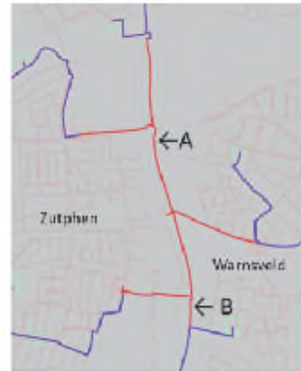
Figuur 1: kaart van de omgeving van de werkzaamheden. Het deel te vervangen nodulaar gietijzeren 8 bar leiding is het leidingdeel tussen punten A & B. De te verwachtien druk volgens het werkplan is in kleuren aangegeven (rood: drukloos, blauw: op druk blijvend)
